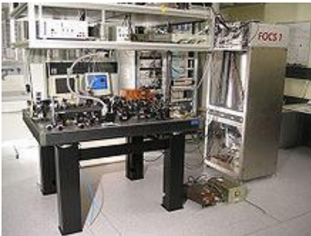
FOCS 1, un rellotge de cessi suis de 2004 d'una precisió d'1 s en 30 milions d'anys
